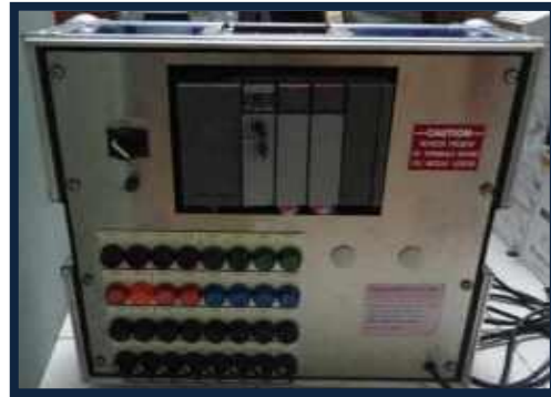
Allen Bradley SLC 5/03
